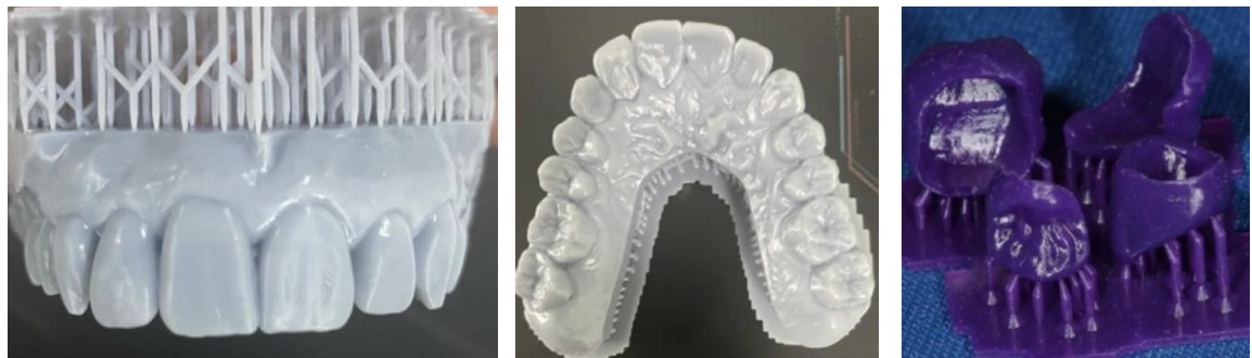
Imágenes 24, 25 Impresión de modelos de arcadas dentales. Imagen 26 patrones calcinables para restauraciones cerámicas.
